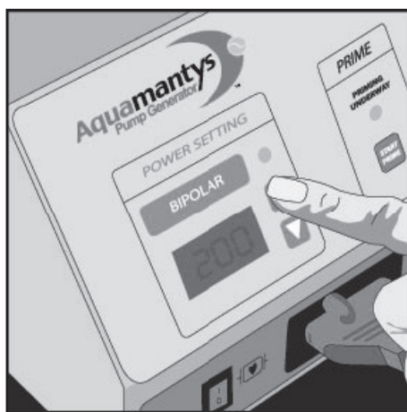
Рис. 10-2. Регулировка настройки высокочастотной мощности
