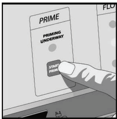
Рис. 4-7. Включение заполнения устройства
