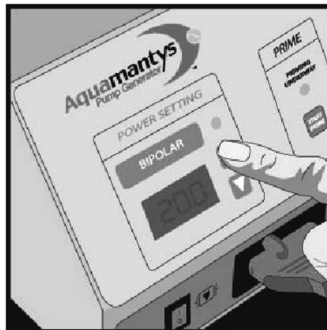
Rysunek 4-8. Regulacja ustawienia mocy o częstotliwości radiowej
