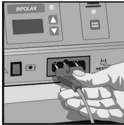
Figur 4-1. Sette anordningens plugg inn i Aquamantys™ Pump Generator
