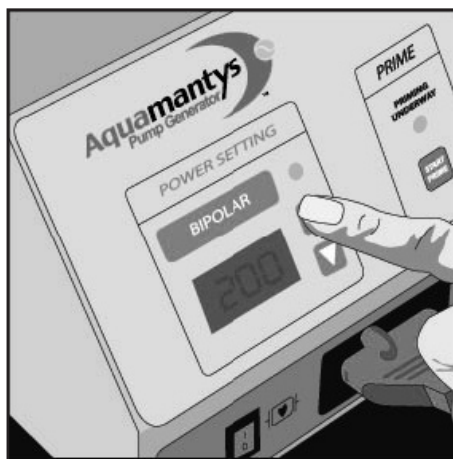
Abbildung 10-2. Anpassen der HF-Stromleistungseinstellung
