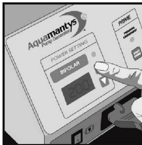
Abbildung 4-8. Anpassen der HF-Stromleistungseinstellung
