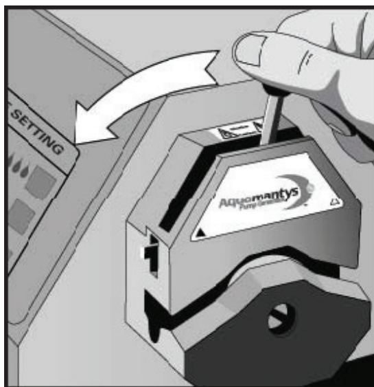
Fig. 4-2. Pumpehovedet løftes op
